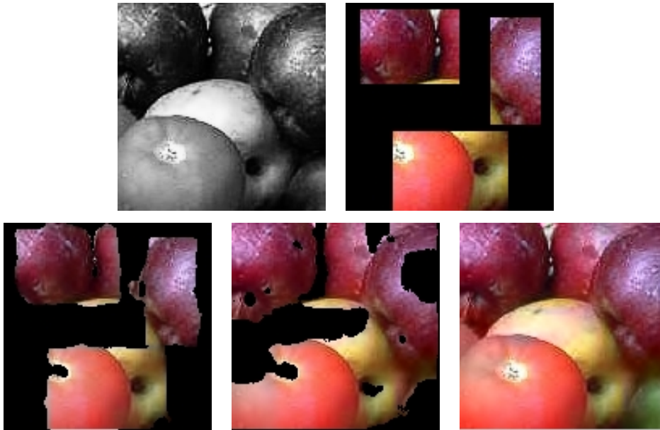
ABBILDUNG 2.22: Oben: Grauwertbild, partielle Farbbildinformation; unten: iterative Rekonstruktion.
