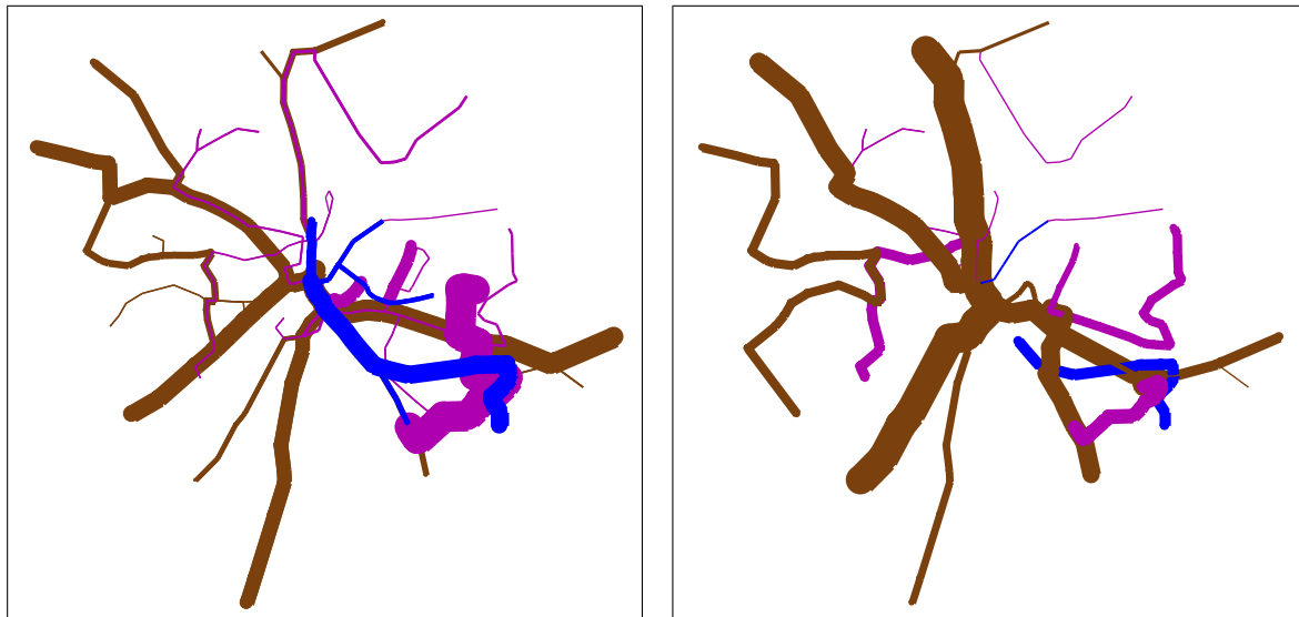
ABBILDUNG 2.43: Linienplanung. Links: Bestehende Linien in Potsdam 1998. Rechts: Durch ein Greedy-Verfahren berechnetes Liniennetz. Die Liniendicken sind jeweils proportional zur Frequenz der entsprechenden Linien. (Webversion ist farbig)
