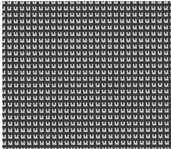
ABBILDUNG 2.3: Elektronenmikroskopische Aufnahme einer periodischen Anordnung von Split-Ring-Resonatoren (Aufnahme zur Verfügung gestellt von S. Linden, Karlsruhe). Diese miniaturisierten Schwingkreise besitzen Resonanzfrequenzen im sichtbaren Spektralbereich und können deshalb durch das magnetische Feld sichtbaren Lichts angeregt werden. Der Ausschnitt hat eine Größe von etwa 8,5 \times 7,6 \mu\text{m} , die gesamte Größe der in Karlsruhe hergestellten Struktur beträgt etwa 100 \times 100 \mu\text{m} . Die Dicke der Split-Ring-Resonatoren beträgt 30 nm.
