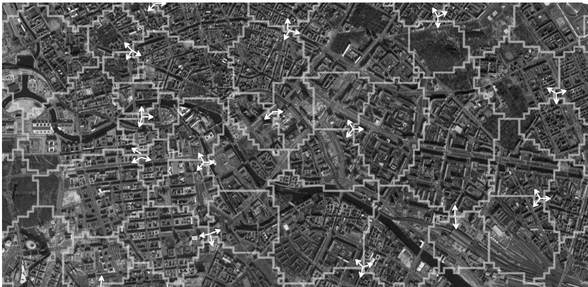
ABBILDUNG 2.39: Ein UMTS-Funknetz in der Berliner Innenstadt (schematische Darstellung). Durch die Antennen (Pfeile) wird das Gebiet in Zellen aufgeteilt.
