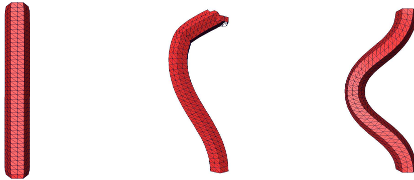
ABBILDUNG 2.35: Auslenkung eines prismatischen Stabes durch axiale Verschiebung. Links: lineare Elastomechanik. Mitte: geometrische Nichtlinearität. Rechts: kompressibles Ogden-Material.
