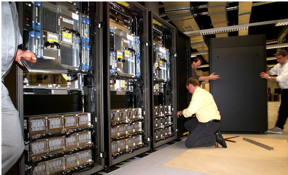
ABBILDUNG 4.1: Installation des IBM p690 am ZIB, ©Peter Meißner, Berlin
