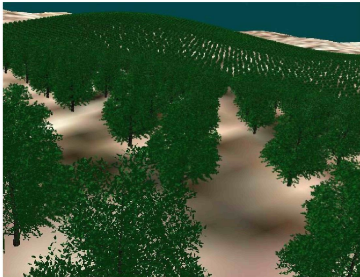
ABBILDUNG 2.28: 3D-Sicht auf eine Wald-Szene, bestehend aus Dreieck- und Punkt-Primitiven. Bei herkömmlicher polygonaler Repräsentation würde diese Szene mit 50 \times 50 Bäumen insgesamt 625 Millionen Dreiecke enthalten.
