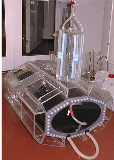
ABBILDUNG 2.16: Modularer MR-kompatibler Experimentalapplikator für die Tiefen-Hyperthermie im Becken- und Abdomenbereich und eines seiner zwölf Antennenmodule.
