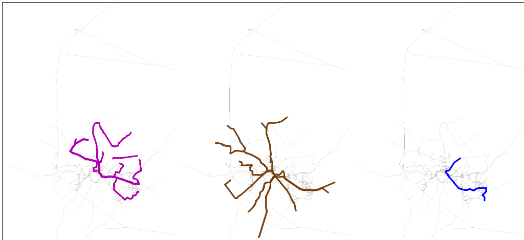
ABBILDUNG 2.53: Linienminimaler Linienplan für Potsdam aufgeschlüsselt nach den drei Transporttypen (von links Stadtbus, Regionalbus, Tram).
