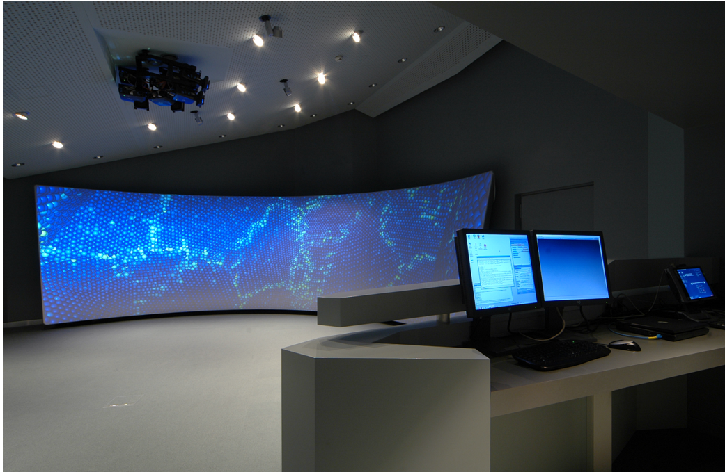
Abbildung 3.1: Studio da Vinci. Die Fotografie zeigt das Forschungslabor Visualisierung aus dem Blickwinkel eines Vorführenden. Rechts sind die Monitore zu sehen, von denen die Projektion auf der gekrümmten Leinwand in der Bildmitte gesteuert wird. Oben links sind die sechs Projektoren zu sehen, die benötigt werden, um auf den drei Segmente der Leinwand jeweils zwei Bilder zu überlagern. Dies ermöglicht die Darstellung stereoskopischer Bilder.
