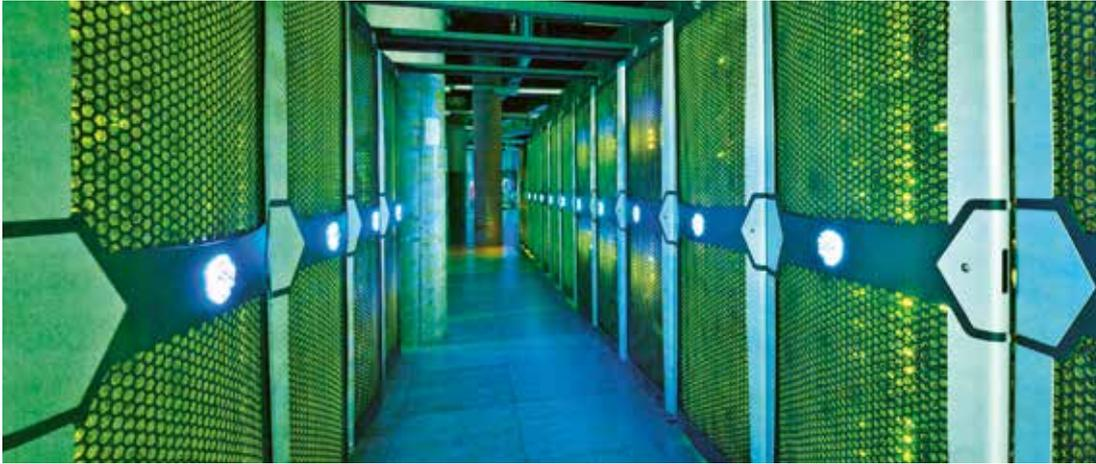
◀ Das HLRN-System am ZIB umfasst insgesamt 49 Computerschränke. Dabei befinden sich die Rechnersysteme in 28, die Plattensysteme in 13, die InfiniBand-Netzwerk-Switches in sechs und die Verwaltungsserver in zwei Schränken.
