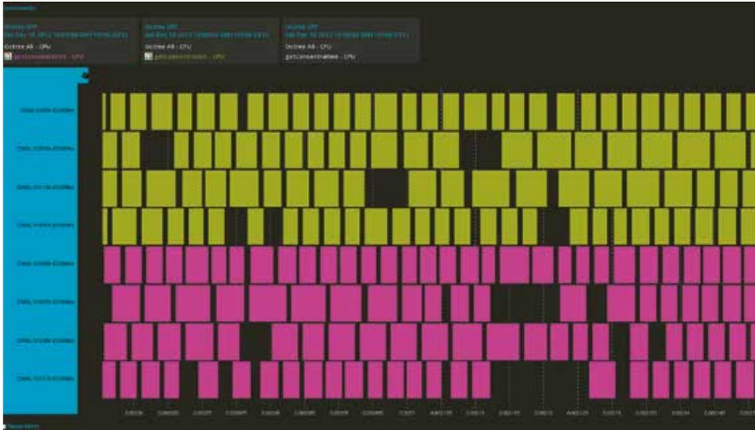
◀ Die Abbildung zeigt die Visualisierung von Laufzeitdaten mit der in ENHANCE entwickelten Web-Applikation „EPerF Analyzer“. Mehrere Laufzeitexperimente, hier in unterschiedlicher Farben zwei Messungen der Anwendung Otree auf CPUs und GPU, können in übersichtlicher Weise analysiert werden.
