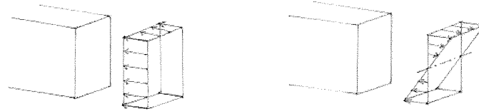
Abb 1.16 Der Spannungsverlauf im Balken bei mittiger Druckkraft und unter Biegemoment ohne Normalkraft. Alle Fasern sind bei mittiger Normalkraft gleichmäßig beansprucht. Unter Biegung sind nur die Randfasern extrem beansprucht.
