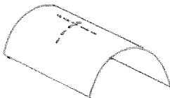
Abb 1.25 Die einfach gekrümmte Tonne wird durch Translation einer gekrümmten Erzeugenden an einer geraden Leitlinie erzeugt.
