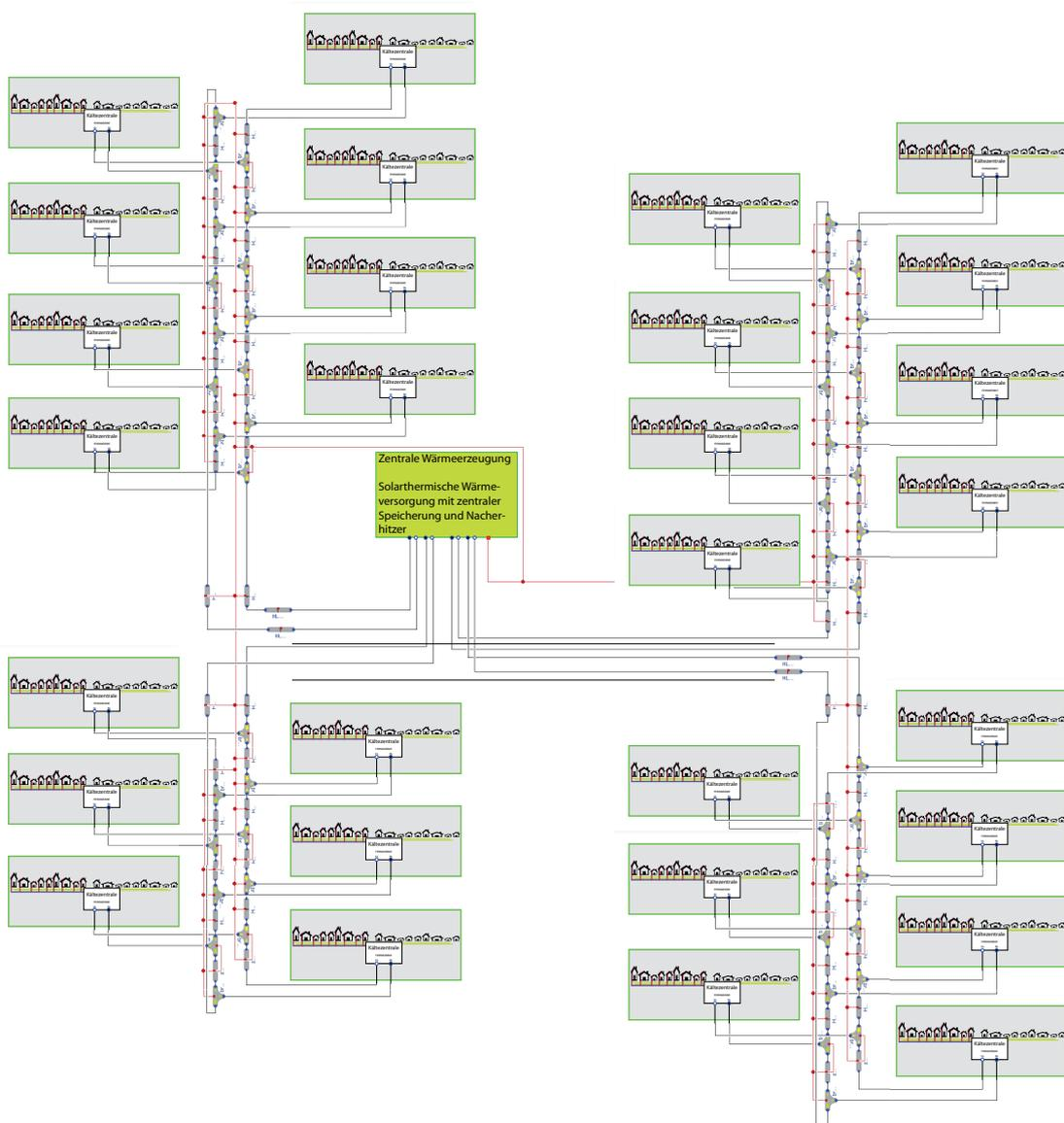
Abbildung 115: Simulationsmodell des Wärmenetzes inklusiv der Energiezentrale (Mitte) sowie den 29 Quartieren als Abnehmer.
