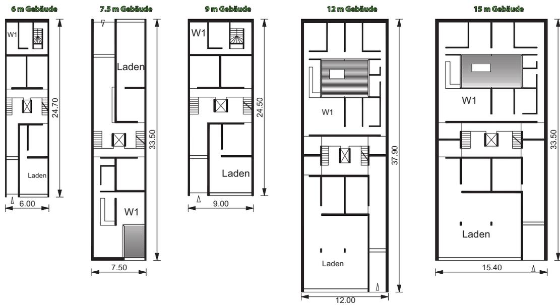
Abbildung 56: Grundrisse der verschiedenen Wohngebäude (Erdgeschoss)
