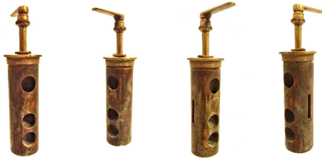
Abbildung 72: Ventilposaune. Johann Wendelinus Weisse, Berlin 1828–1833. 3 Pumpventile nach einem verbesserten Stölzel-Typ. Detailansichten des Ventilkolbens vom dritten Ventil. Deutlich zu erkennen ist der Führungsschlitz zur Aufnahme der am Ventilgehäuse befestigten Schraube. Scenkonstmuseet – The Swedish Museum of Performing Arts, Inv.-Nr. F133.
