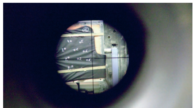
Abb. 2: Blick durch das Zielfernrohr der Beschussapparatur auf die am Plastilin-Block befestigte Schutzweste mit Kreidemarkierungen
