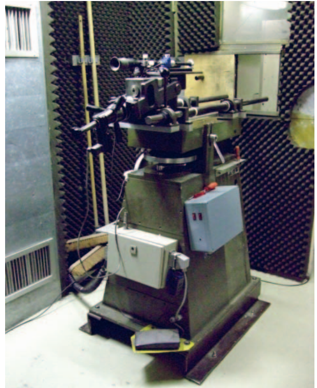
Abb. 1: Beschussvorrichtung in Mellrichstadt; der Waffenlauf zeigt in Richtung des kleinen Fensters
