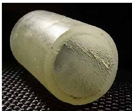
Abb. 4) PE-Rohr nach 34 Jahren Gebrauch in einer Fußbodenheizung. (Durchmesser 17 mm, Wandstärke 2 mm)
