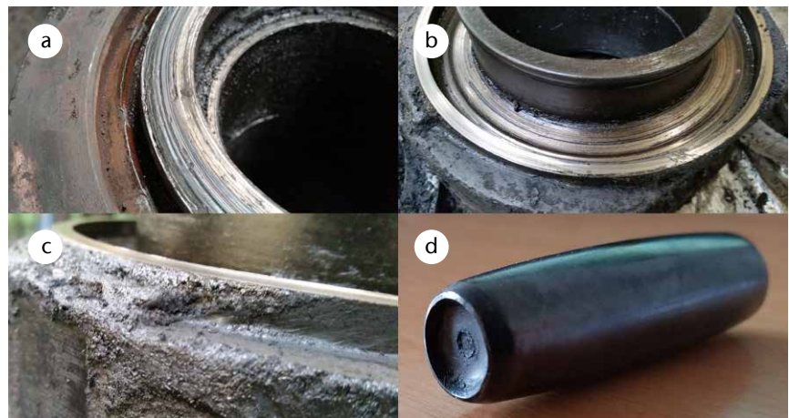
Abb. 9) Zusammengefasste Schadensbilder bei der Demontage der Rolleneinheit
