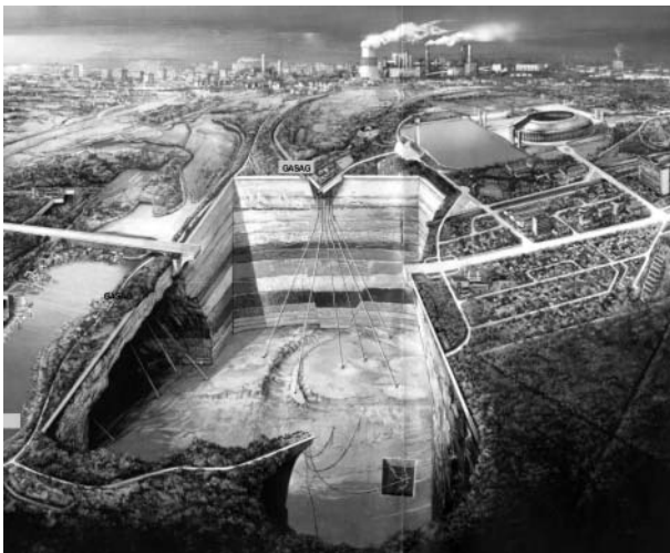
Abb. 1: Erdgas-Untertagespeicher mit Tiefbohrungen für Förder sonden
