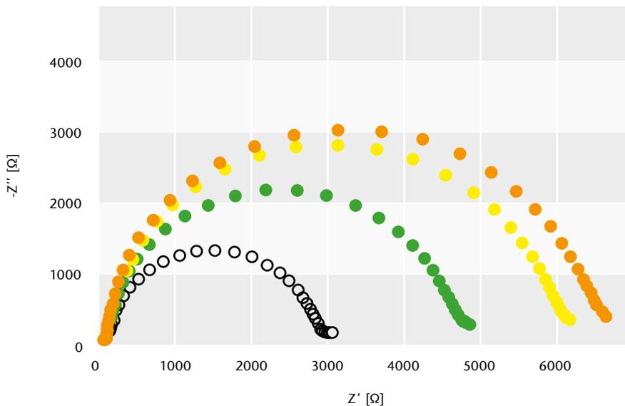
Abb. 6 Impedanzspektren einer DNA-modifizierten Goldchipelektrode vor (weiß) und nach der Hybridisierung mit 45mer (grün), 45mer(eü:5) (gelb) und 45mer(eü:10) (orange) Ziel-DNA (eü:5 und eü:10 bedeutet, dass ein Überhang von 5 oder 10 Nukleotiden zur Elektrode ausgerichtet ist).
