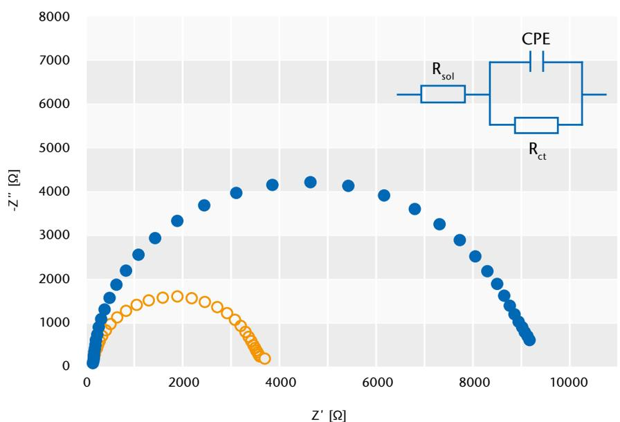
**Abb. 1)** Im Nyquist-Plot dargestellte Impedanzspektren einer DNA-modifizierten Goldchipelektrode im denaturierten (weiß) und hybridisierten Zustand (blau). Inset: Das in dieser Arbeit für die Analyse der Daten verwendete Ersatzschaltbild ( $R_{sol}$  – Lösungswiderstand,  $R_{ct}$  – Durchtrittswiderstand, CPE – konstantes Phasenelement, welches die Doppelschichtkapazität repräsentiert).
