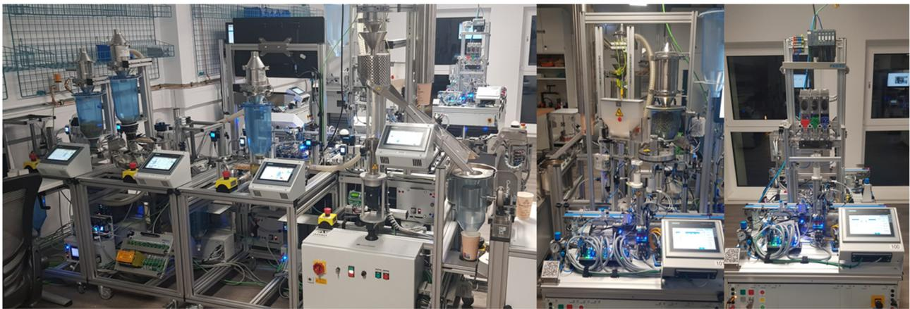
Abbildung 3: Bypass-Strecke zur Maiskornbereitstellung inkl. Popcorn-Produktion sowie die Stationen Abfüllen von Schüttgütern und Pillen gemeinsam weiterentwickelt mit der Firma ADIRO
