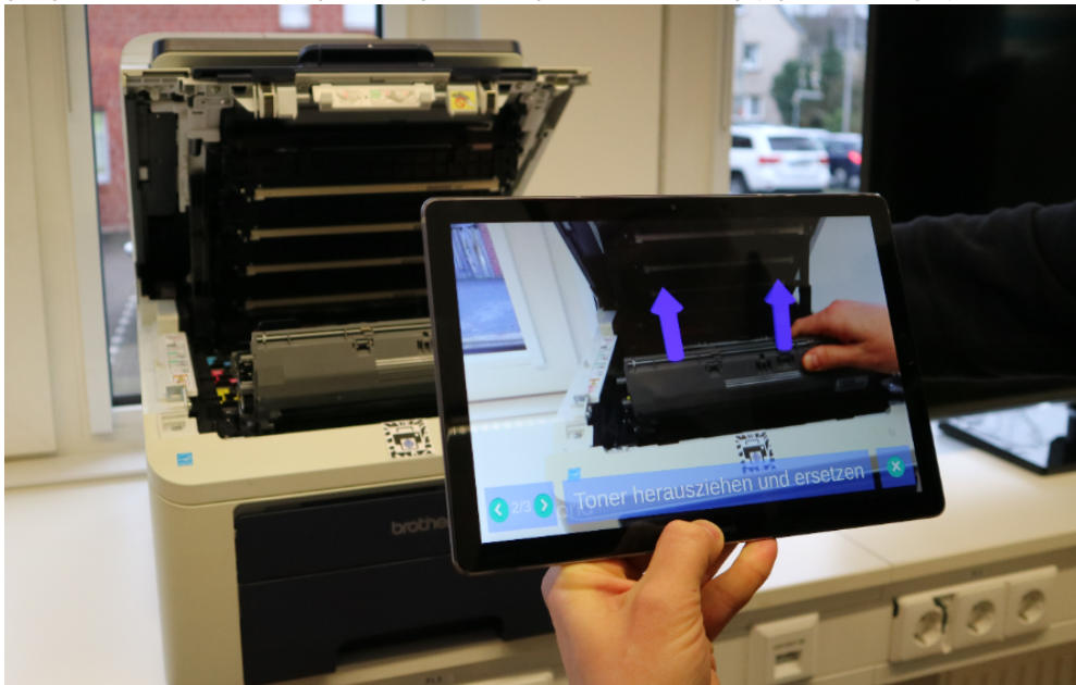
Abbildung 1: Augmented Reality gestützter Tonerwechsel im digi.lab der FH Münster
