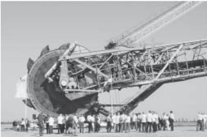
Dimensionen, die auf kein Foto mehr passen: Die Gäste der Feierstunde wirken winzig vor dem haushohen Schaufelrad des Baggers. Auch alle anderen Maße des Geräts beeindruckten. Der 1964 gebaute Bagger hat eine Länge von 171 m und eine Höhe von 51 m – zum Vergleich: Der Klettwitzer Kirchturm misst bis zu seiner Spitze knapp 40 m.
