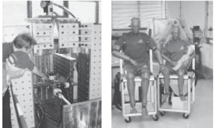
*links:* Jürgen Bahnert (im Hintergrund) von der DEKRA erläutert hier einem Besucher den Dauertest einer Anhängerkupplung. Die Gäste waren erstaunt, welchen Belastungen Stahlteile ausgesetzt werden, bevor sie serienweise zum Einsatz gelangen.
