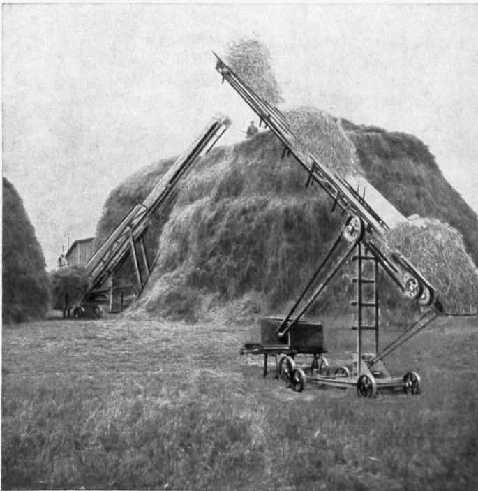
Abb. 3. Steilförderer aus Stahlrohren und -blechen
