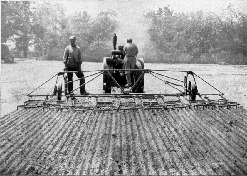
Abb. 1. Anhängervorrichtung aus geschweißten Stahlrohren für große Arbeitsbreiten
