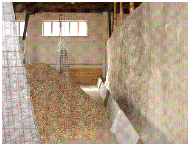
Bild 8: Einbau der Trockenmiete in eine Lagerhalle
