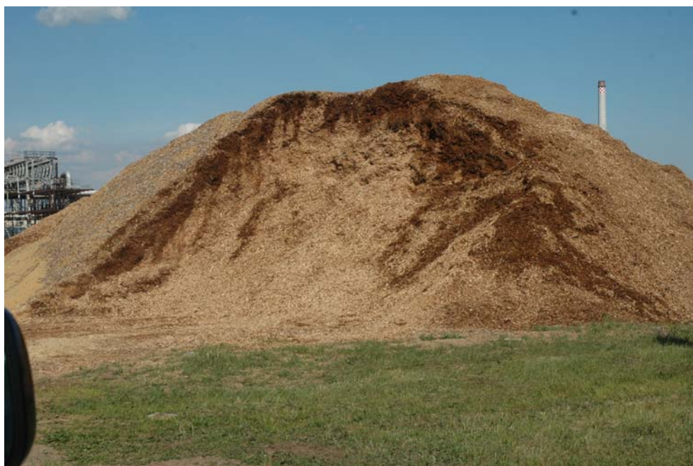
Bild 2: Hackschnitzelhalde nach ca. einem Jahr Lagerung. Die äußere Schicht (0,2 – 0,7 m in die Halde) hatte eine dunkle Verfärbung aufgrund des erhöhten Wassergehaltes. Innerhalb der Halde (> 0,7 m in die Halde) waren die Wassergehalte niedriger als in der äußeren Schicht
