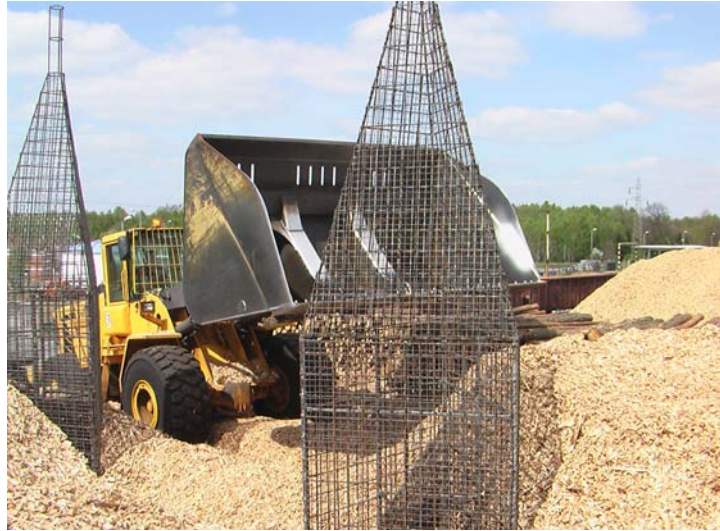
Bild 6: Versuchsmiete Vortrocknung, Schütten der zweiten Schicht
