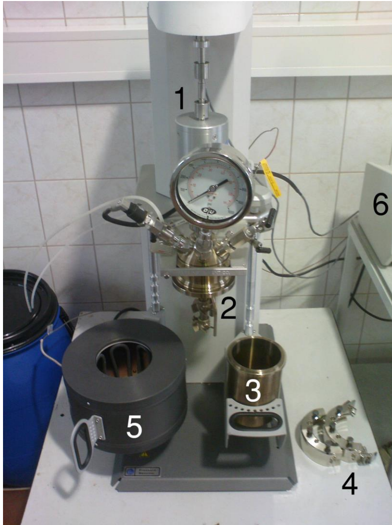
Abb. 51: Aufbau des labortechnischen 1-L HTC-Reaktors
