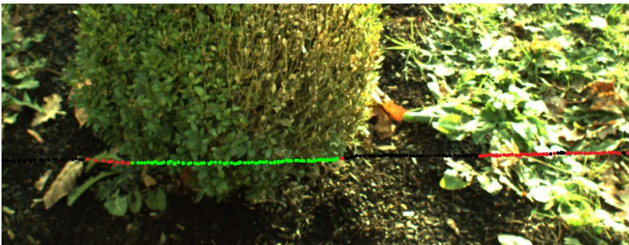
Bild 4: Beispiel für die Klassifikationsergebnisse. Rot gekennzeichnete Punkte wurden als Unkraut erkannt, schwarze als Erde und grüne als Buchsbaum.
