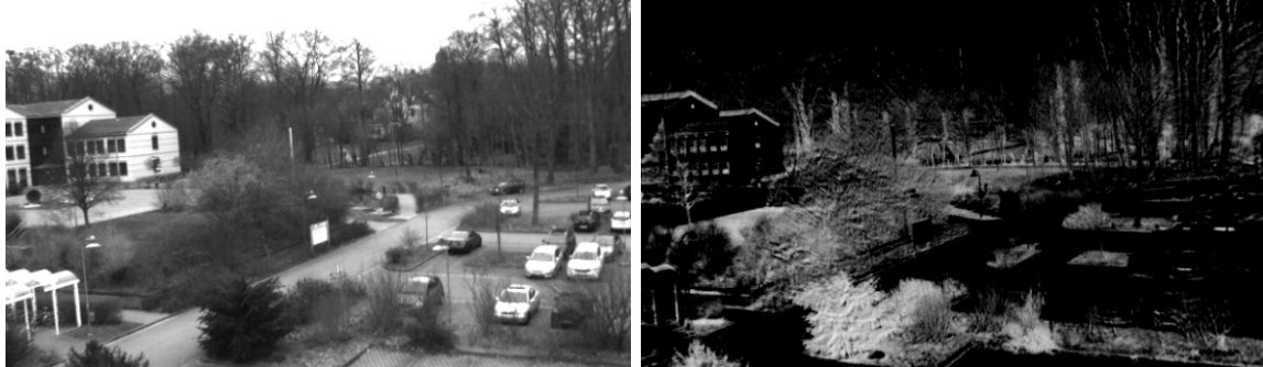
Abbildung 4: Luftaufnahme im sichtbaren Bereich (links) und das NDVI-Bild (rechts)
