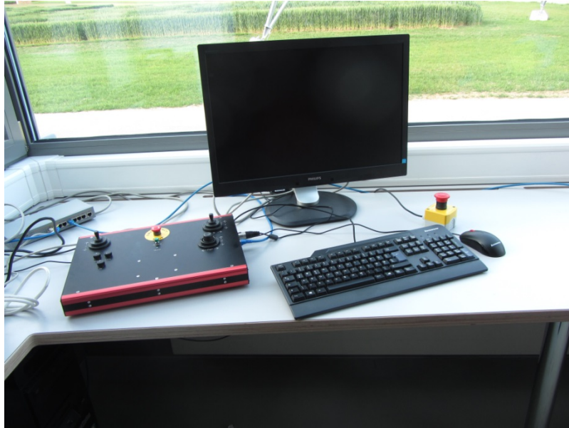
Abbildung 2: FIP Steuerstand mit Kontrollpanel, Monitor, Maus Tastatur des Kontrollcomputers und Notaus.
