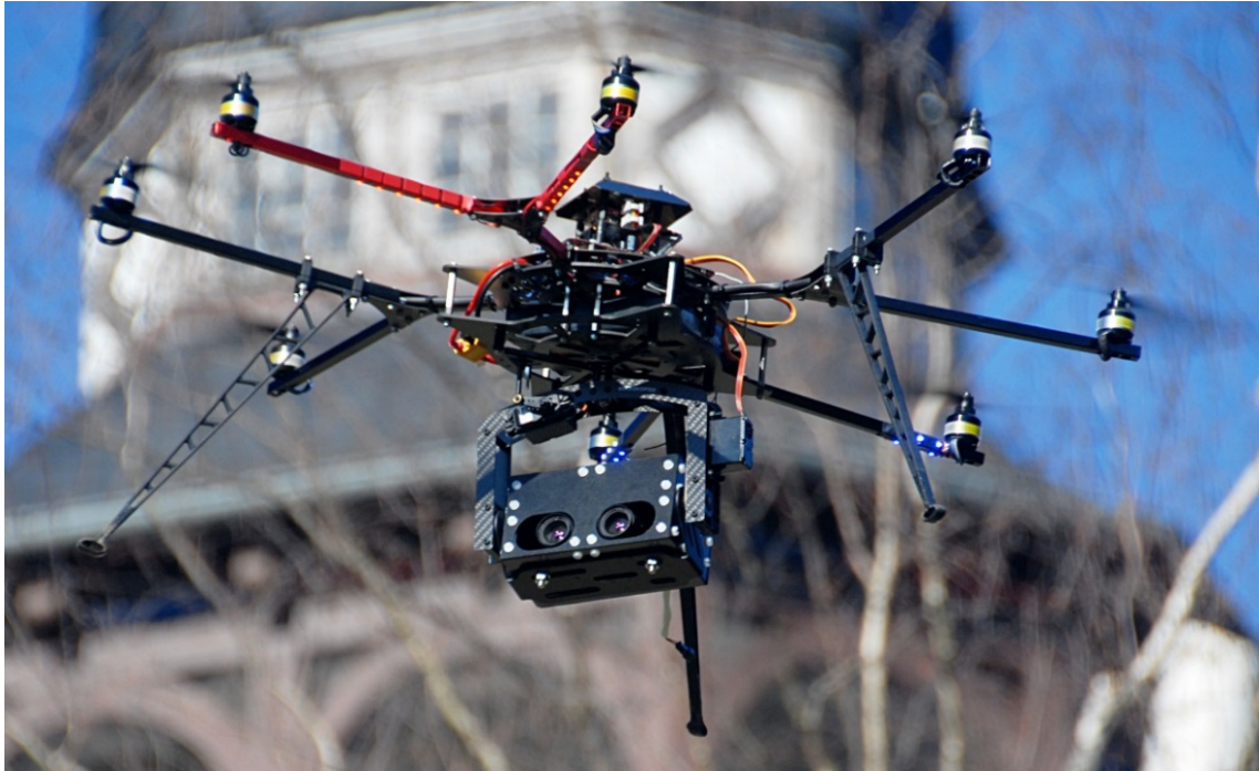
Abbildung 1: Multikopter der Hochschule Harz mit montierter Smart-Kamera
