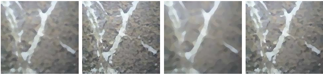
Abbildung 6: Shockfilter mit festem 3 x 3 Strukturelement angewendet auf die mit dem Median gefilterten Bilder. Links: Medianfilter mit festem Strukturelement. Mitte links: Medianfilter mit adaptiven Strukturelement. Mitte rechts: 3-mal Medianfilter mit festem Strukturelement. Rechts: 3-mal Medianfilter mit adaptiven Strukturelement.
