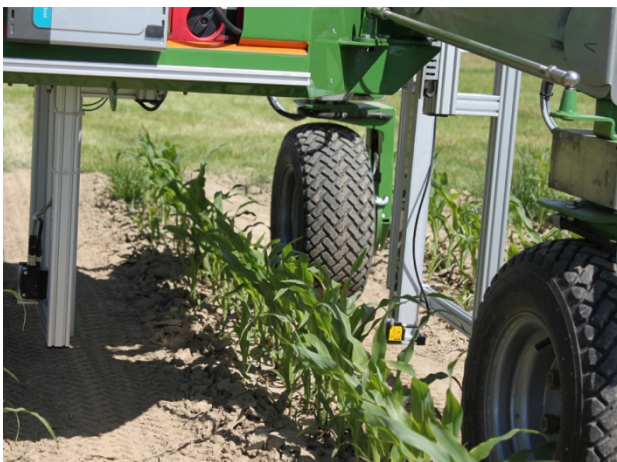
Bild 4: Feldmessungen mit bildgebenden Lichtgittern in Mais mit dem autonomen Feldroboter BoniRob (links) und der Phänotypisierungsplattform BreedVision in Triticale (rechts) nach BUSEMEYER et al. 2010 sowie dort aufgeführter Referenzen.
