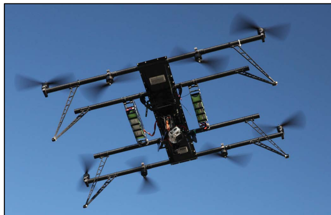
Bild 1: Oktokoptervariante des HORUS mit Kameramodul
