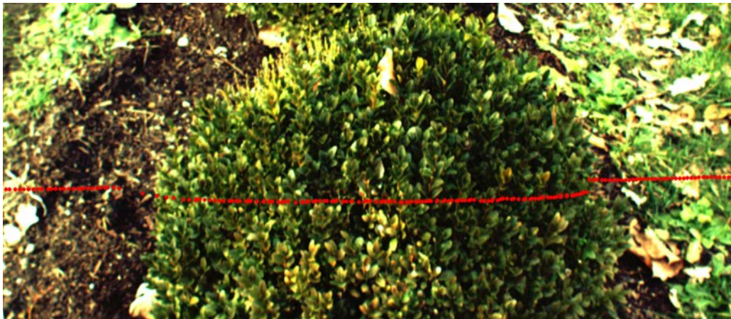
Bild 2: Für die rot markierten Bildpunkte liegen Entfernungsmessungen des 2D-Laserscanners vor.
