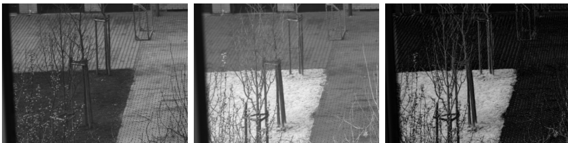
Bild 6: Aufnahme im VIS- (links) bzw. NIR-Bereich (Mitte) und das Differenzbild (rechts)
