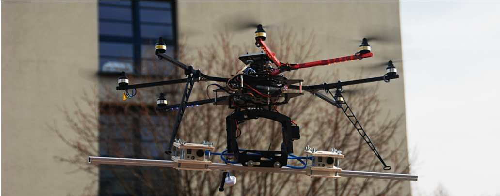
Bild 1: Multikopter der Hochschule Harz mit montierter Stereokamera (2 Actionkameras)
