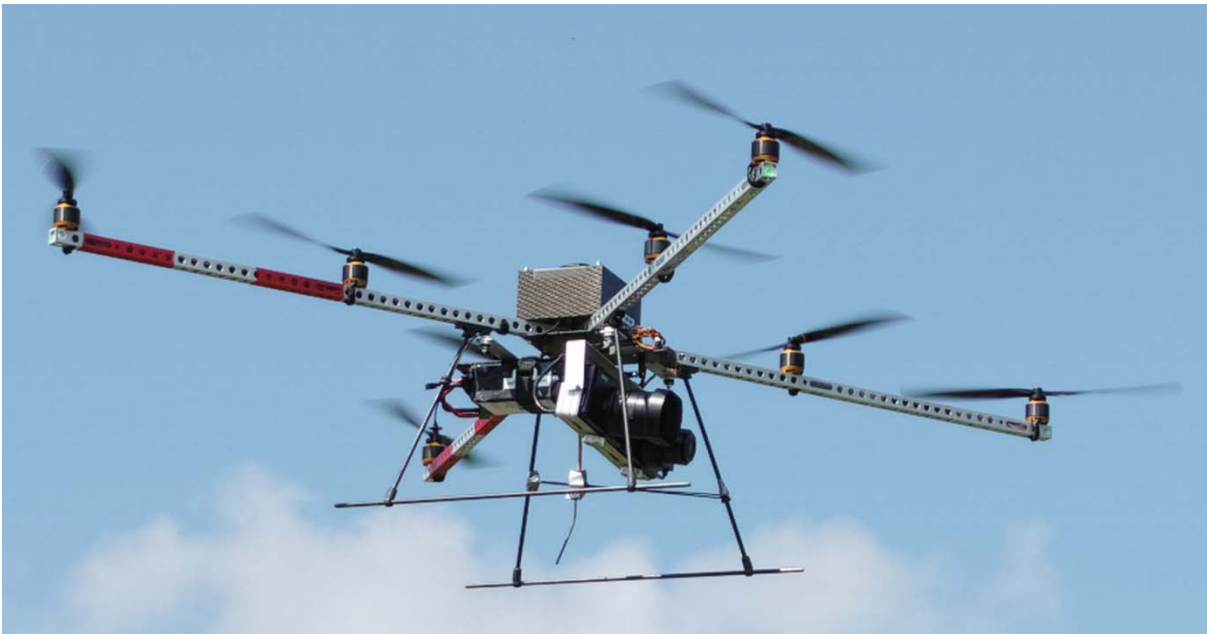
Bild 1: UAV MR-X8 mit Sigma DP2 Sensorkopf
