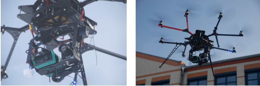
Bild 3: Multikopter der Hochschule Harz mit montierter Wärmebildkamera
