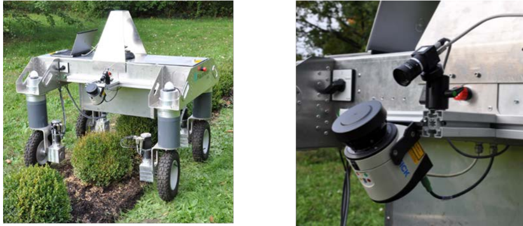
Bild 1: Der mobile Roboter IOSB.amp O1 (links) und der Sensorkopf, bestehend aus 2D-Laserscanner und Kamera (rechts).
