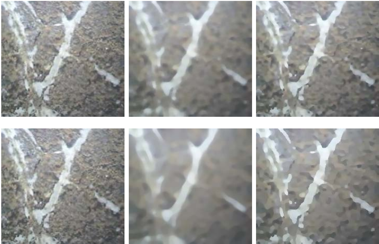
Abbildung 5: Links oben: Originalbild. Mitte oben: Medianfilter mit festem Strukturelement. Rechts oben: Medianfilter mit adaptiven Strukturelement. Links unten: Originalbild. Mitte unten: 3-mal Medianfilter mit festem Strukturelement. Rechts unten: 3-mal Medianfilter mit adaptivem Strukturelement.
