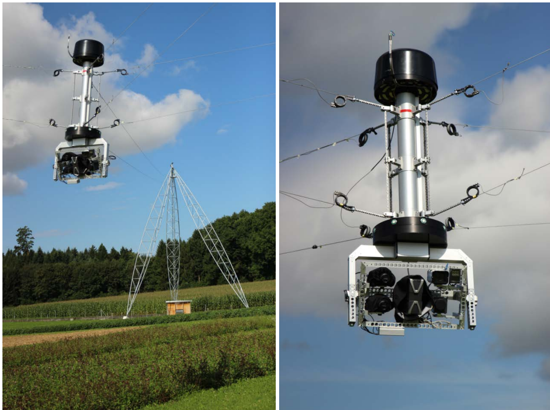
Abbildung 3: links Sensorkopf, Mast an der Feldecke mit Haus zum Schutz der Winden. Rechts: Detailaufnahme des Sensorkopfes. Im oberen Gehäuse sind die Akkus, die Spektrometer und der Steuerrechner für die Sensoren untergebracht, das untere schwarze Gehäuse beherbergt Ultraschallsensoren und den Antrieb der Pan-Achse. Unten ist der Sensorrahmen zu sehen an dem links die Canon DSLR Kameras, in der Mitte der Laserscanner und rechts die Thermokamera, sowie die Systemkamera zu erkennen.
