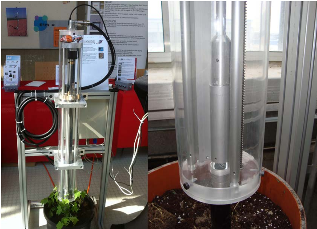
Bild 1: Automatisches Minirhizotronsystem mit automatischer Führung zur Untersuchung des Wurzelwachstums (A), Positionierung der Fingerkamera in den Minirhizotronröhren (B)
