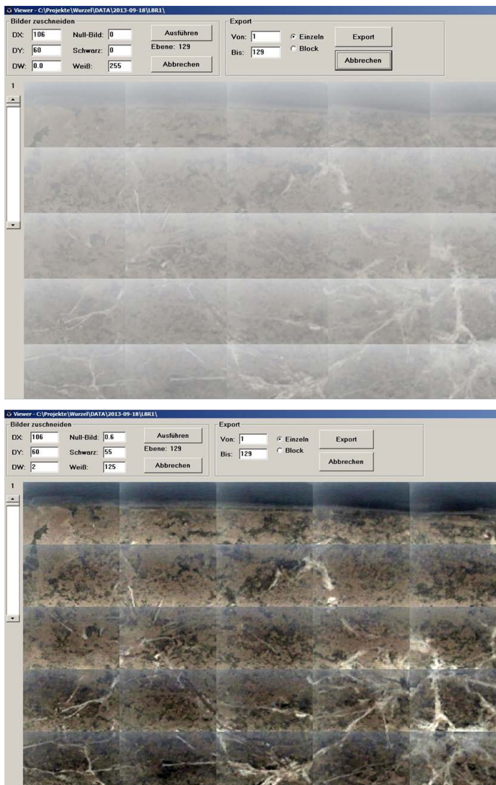
Bild 3: Zusammengesetztes Gesamtbild vor (A) und nach (B) der software-technischen Optimierung. Folgende Schritte wurden durchgeführt: Subtraktion eines Nullbildes, Veränderung der Verteilung der Helligkeitswerte von ursprünglich 0..255 auf einen Bereich von 55..125. Drehung (DW) um 2°.
