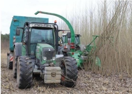
**Abbildung 3:** Anbau-Mähacker für Schlepper mit Rückwärtsfahreinrichtung bei der Pappelernnte (JENZ, GMHT 140)
