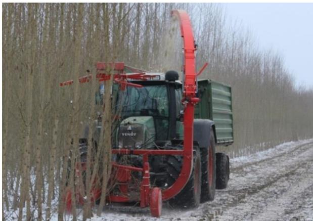
**Abbildung 7:** ATB-Mähhackers als Anbaugerät für Standard-Traktoren im Ernteeinsatz 2013
