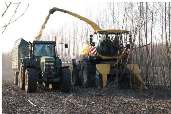
**Abbildung 2:** Feldhäcksler mit Gehölzschneidwerk bei der Pappelernte (New Holland FR9060)
