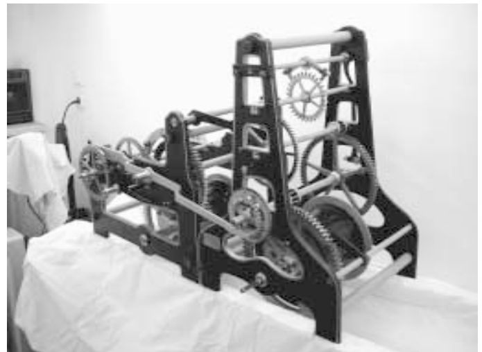
Nach der Entfernung von vier alten Farbschichten kam die ursprüngliche Bemalung wieder zum Vorschein und wurde hergerichtet: Anthrazit-schwarz mit Goldrand. Die mechanischen Teile wurden ausgebaut, gereinigt, geschliffen, gerichtet und wieder zusammengefügt. Nun läuft die Uhr wieder einwandfrei.
