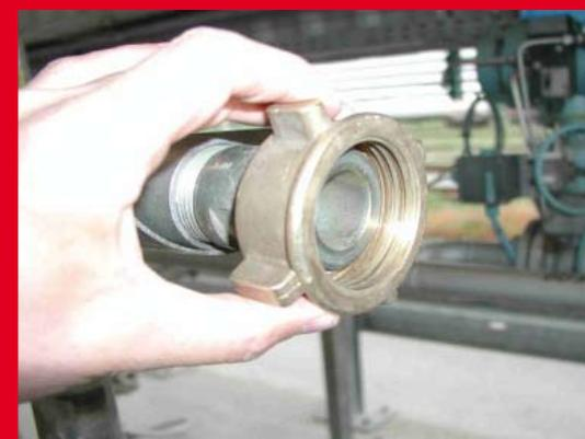
Gewindeanschluss für eine ACME-Verschraubung
