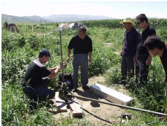
Dichtepfung mit einer leichten Rammsonde auf dem Schwemmfächer des Yongding River
