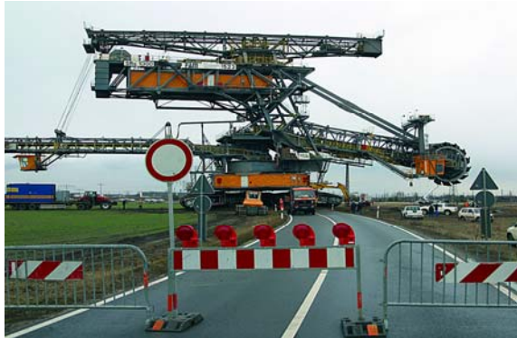
Baggertransport (Foto: Vattenfall)
