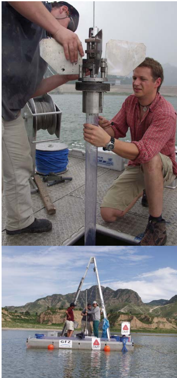
Probennahme mit dem Stechzylinder auf der schwimmenden Bohrplattform des Geoforschungszentrums Potsdam (GfZ)
