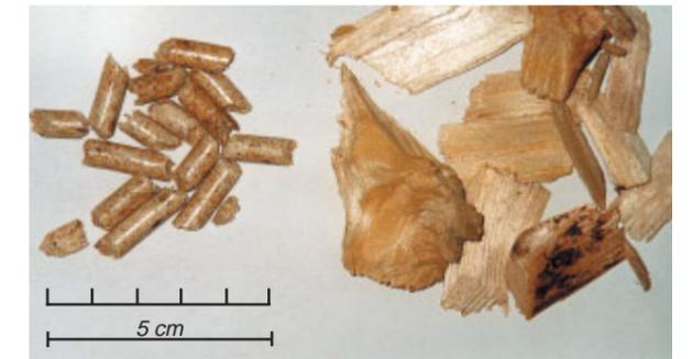
Holzpellets (l.) und Hackschnitzel im Vergleich – Als kleiner und homogener Brennstoff sind die Eigenschaften von Holzpellets sehr gut standardisierbar
