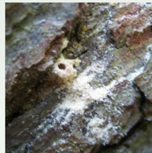
Weißes Bohrmehl als Zeiger für technische Schädlinge
