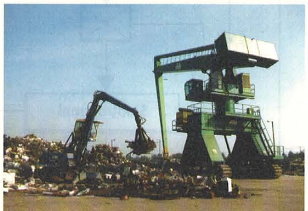
Bild 5: Balancekran und Mobilbagger mit Greifer
