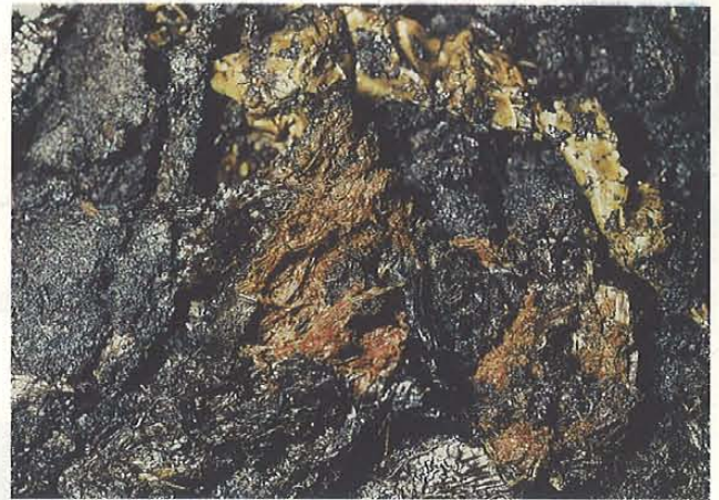
Bild 13: Cladiumreicher Schilf-Basistorf in etwa 15 dm Tiefe bei einer Probebohrung am Südrand der Möllenwiesen
