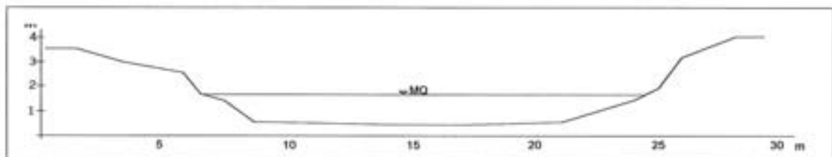
Abb. 16: Beispiel für ein Querprofil am Unterlauf der Nuthe (aus PPM-PROWA 1992)
