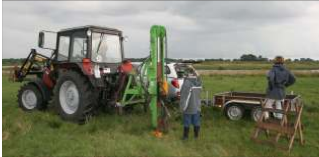
Erkundung einer Beobachtungsfläche mit Hilfe der Rammkernsondierung.
