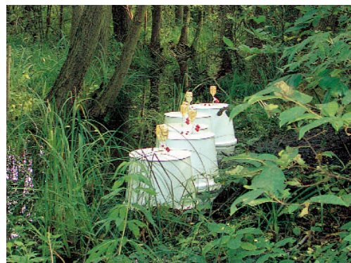
Messung der Emission klimarelevanter Spurengase mit Hilfe von Gassammelhauben aus einem naturnahen Niedermoor mit hohem Grundwasserstand
