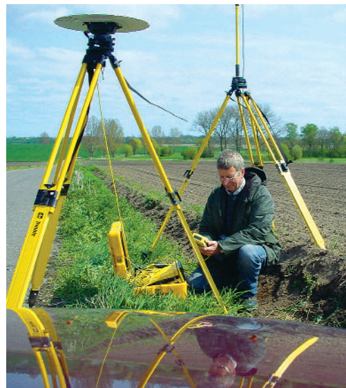
GPS-Einmessung von Dauerbeobachtungsflächen
