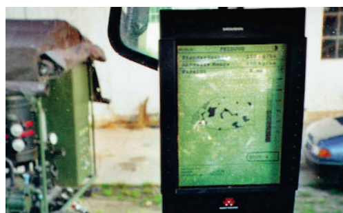
Bordcomputer zur teilflächenspezifischen Bewirtschaftung in einer Schlepperkabine
