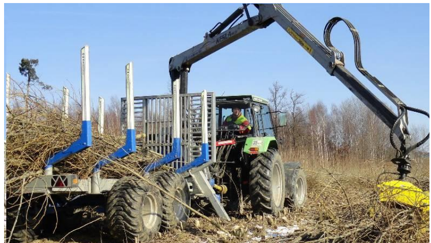
Abbildung 2: Fällen und Bündeln sowie Transport der Bäume bei der motor-manuellen Ernte bei 2 – 4-jährigem Umtrieb (Verfahren 2)
