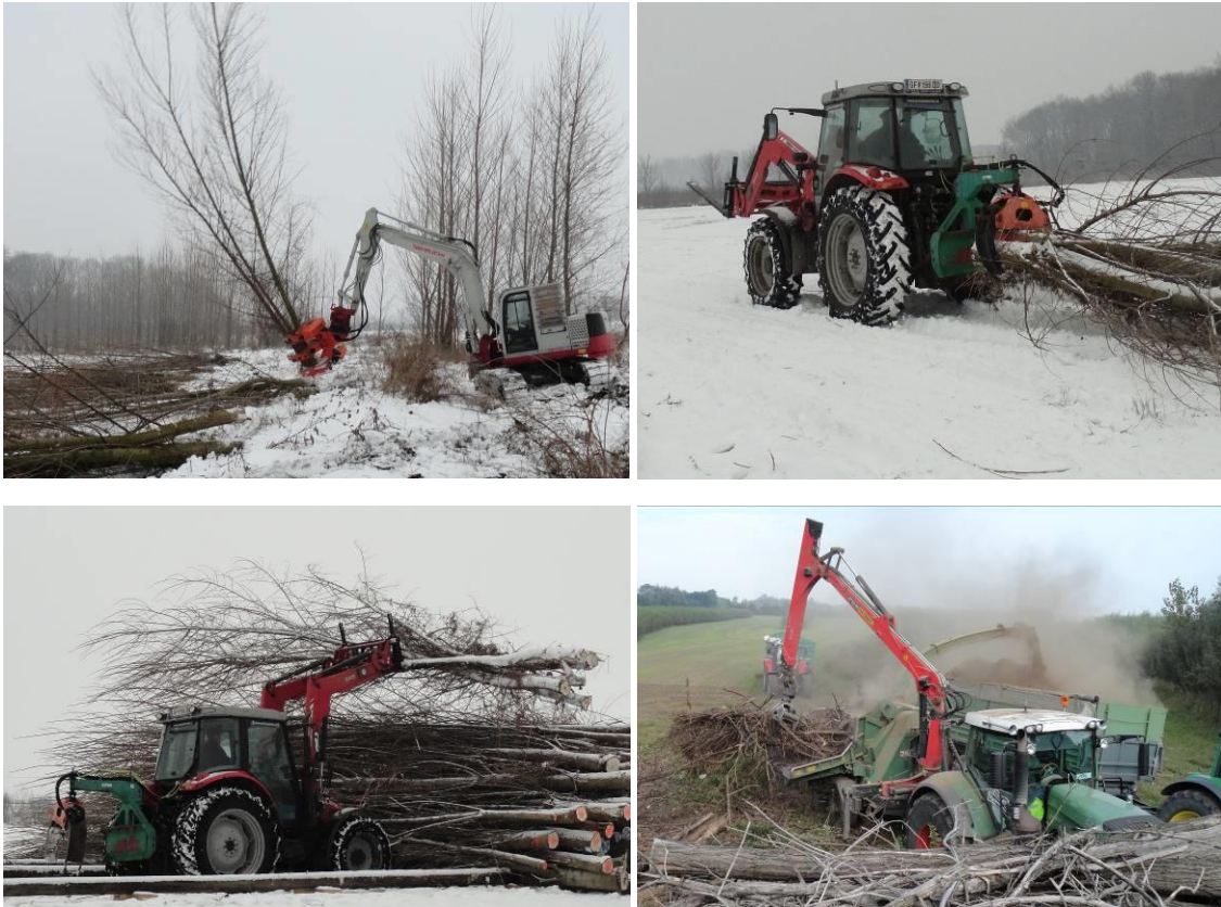
Abbildung 4: Ernte von 5 – 10-jährigen Beständen auf der Basis des Fäller-Bündlers (Verfahren 4)
