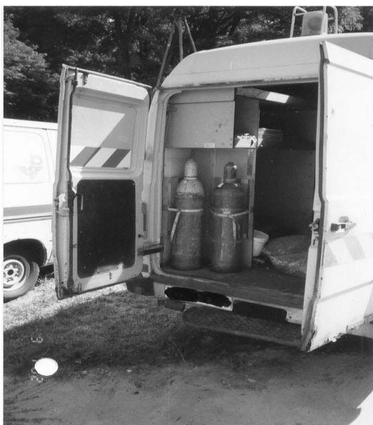
Abbildung 8: Kleintransporter ohne Lüftungsöffnungen und mit unzureichender Transportsicherung (es fehlt eine Fixierung der Flaschen im unteren Bereich)
