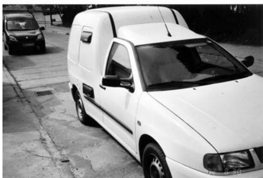
Abbildung 7: Kleintransporter mit ausreichenden Lüftungsöffnungen
