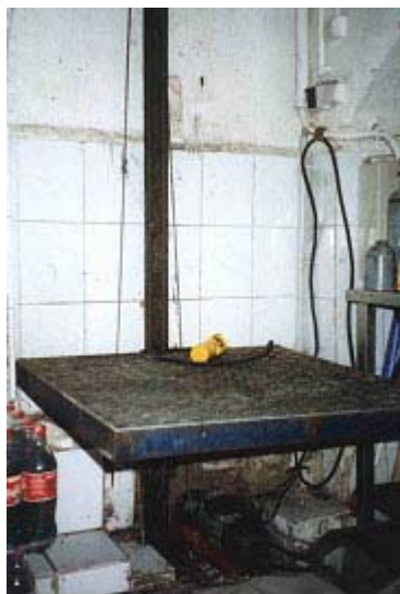
Abbildung 14: Die Eigenkonstruktion der Hebevorrichtung
