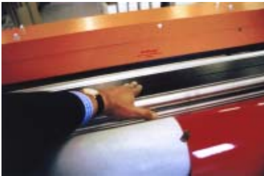
Abbildung 22: eine Hand unter dem Niederhalter (nachgestellt)
