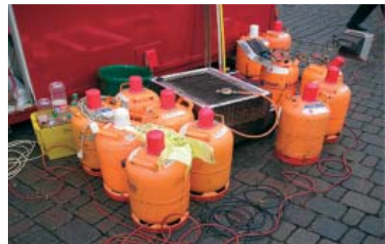
Abbildung 11: Unzureichende Sicherung von Druckgasflaschen vor unbefugtem Zugriff
