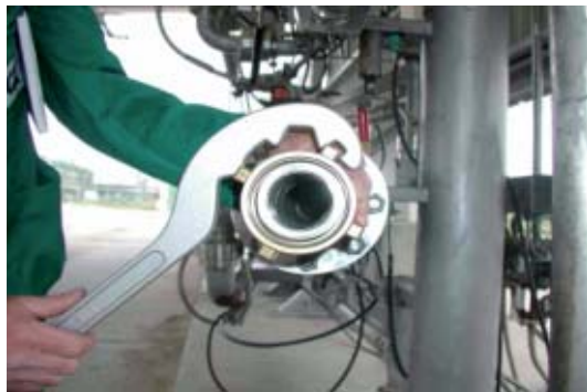
Abbildung 40: ACME-Schlüssel zum Anziehen der ACME-Kupplung
