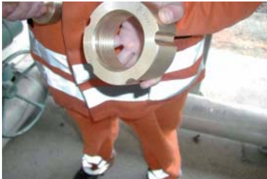
Abbildung 39: Gewindelehre für den Flüssigphaseanschluss
