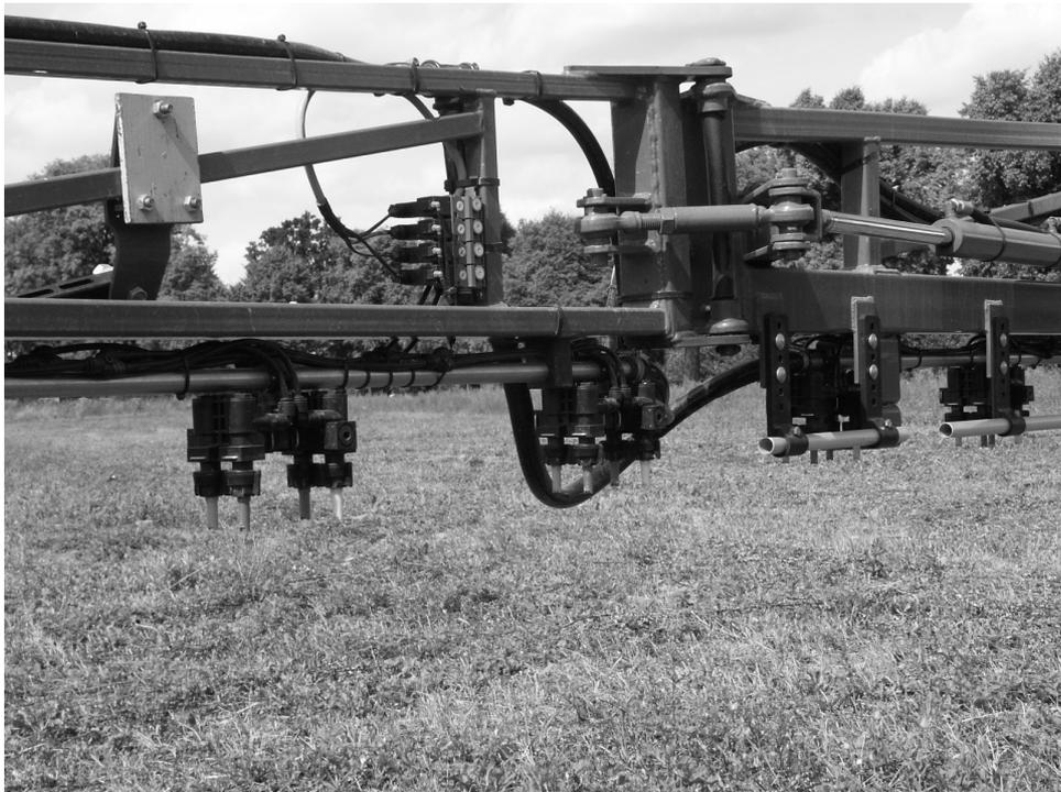
**Bild 15:** Spritzbalken mit den Mehrfach-Düsenträgern
