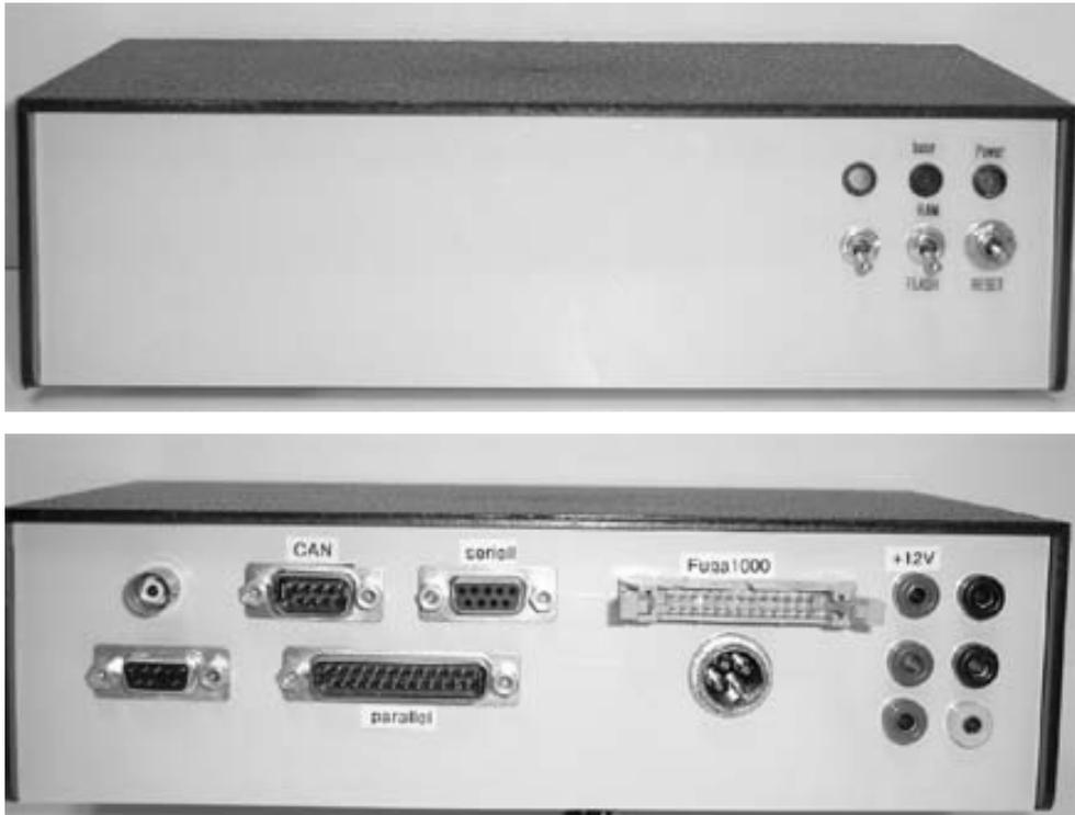
Bild 12: Mikrocontrollerbox (oben: Front-, unten: Rückseite)
