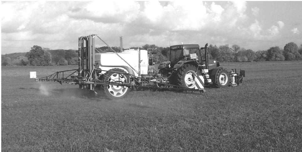
**Bild 13:** Traktor mit Anhängfeldspritze und Unkrautsensor
