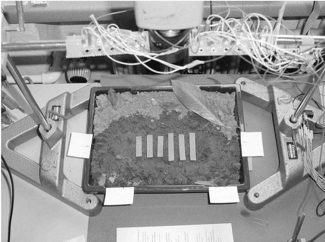
Bild 14: Anordnung der 1 cm breiten Filzstreifen auf dem Sandboden
