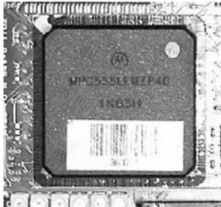
Bild 15: Der MPC555 von Motorola
