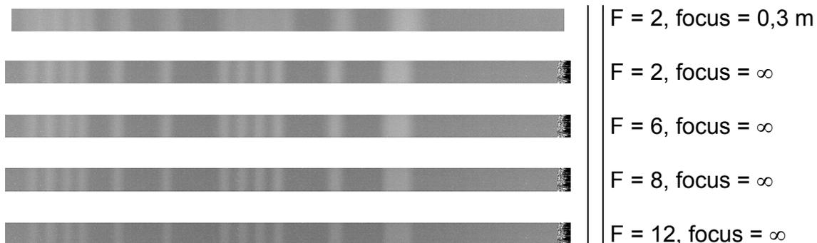
Bild 26: Spektrale Darstellung des ImSpectors bei Aufnahme der bis zu 3 mm breiten Filzstreifen, Vergleich bei verschiedenen Objektiveneinstellungen ; Bildausschnitt 1024 x 40
