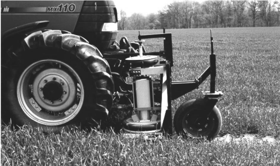
**Bild 6:** Prinzipmuster Diodensensor im Feldeinsatz
