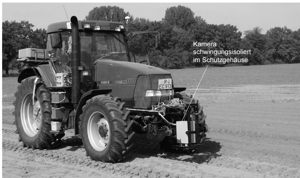
**Bild 61:** Versuchstraktor mit Kamerasystem
