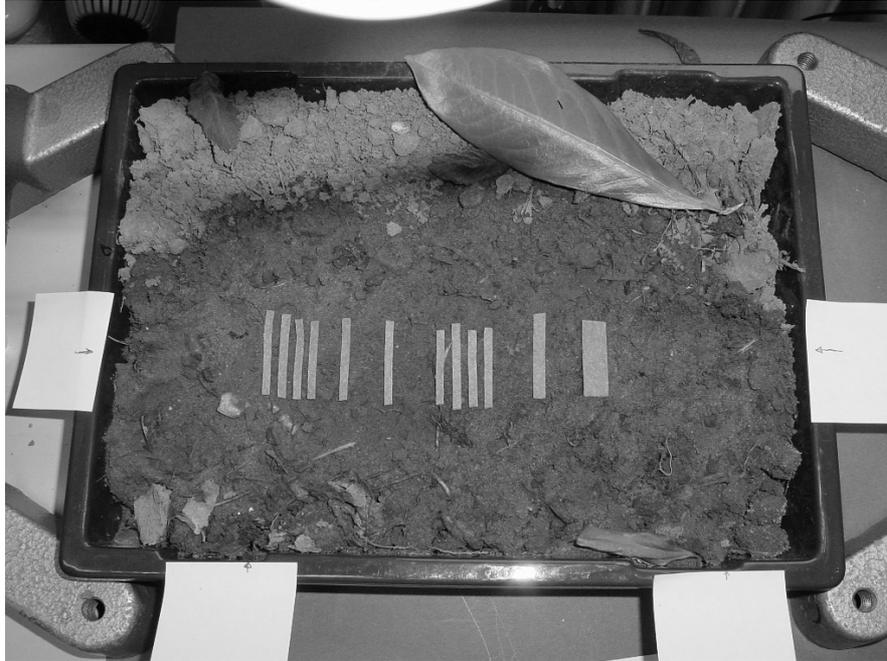
Bild 21: Anordnung der bis zu 3 mm breiten Filzstreifen auf dem Sandboden
