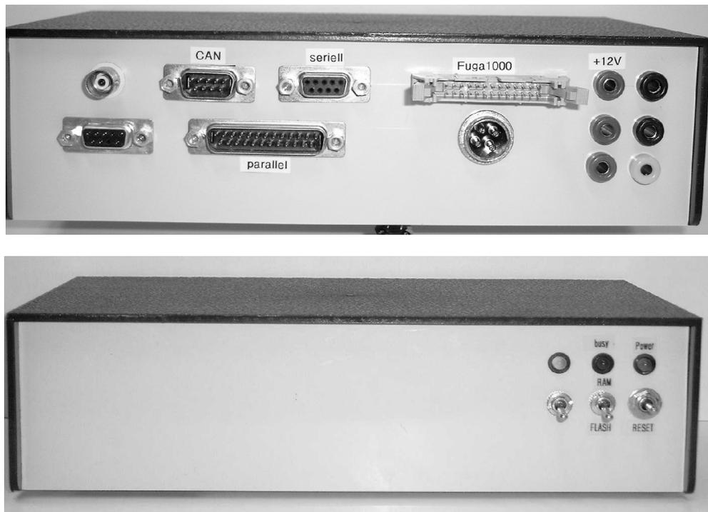
Bild 13: Mikrocontrollerbox (oben: Front-, unten: Rückseite)
