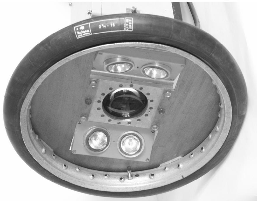
**Bild 8:** Halogenlampen zur Ausleuchtung der Detektionsfläche
