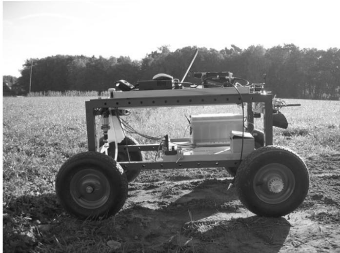
**Bild 23:** Mobiler Messwagen mit Sprayer
