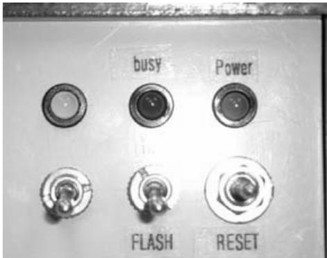
Bild 11: Bedien- und Anzeigeelemente der Mikrocontrollerbox
