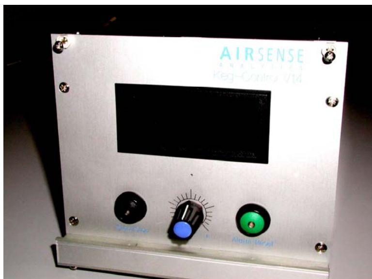
Bild 2-41: Prototyp der elektronischen Nase zum Einsatz an Biogasanlagen „Biogasnase“
