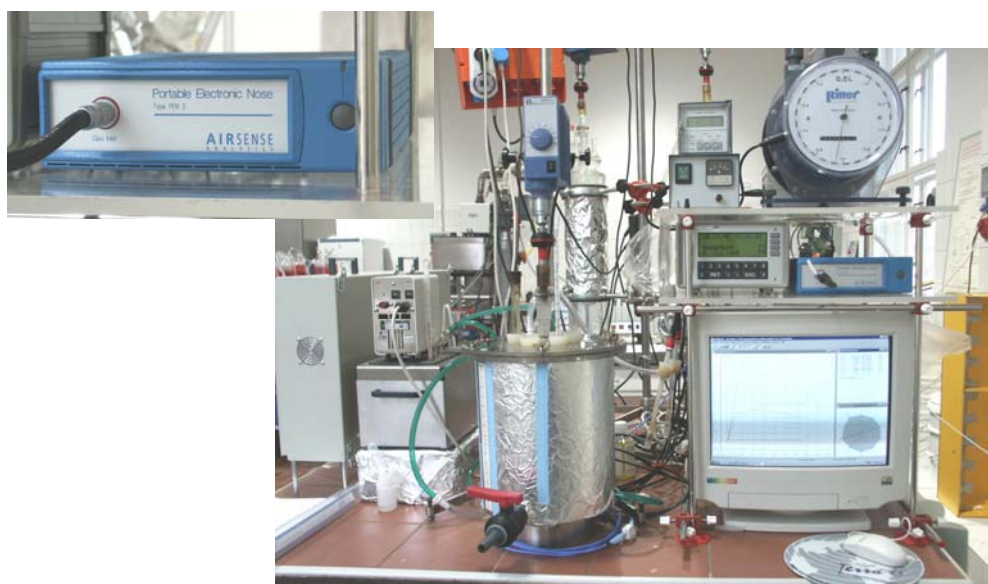
Bild 2-6: Versuchsreaktor mit Gassensorarray im ATB
