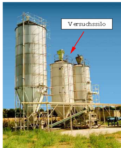
Bild 9: Großtechnische Untersuchungen zur optimalen Anordnung von „cone in cone“-Einbauten in Siloausläufen (HJORTAAS et al. 1997, SCHURICHT et al. 1999)
