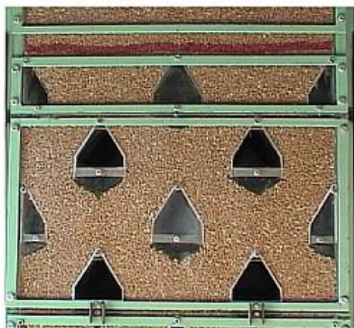
Bild 4: (a) Farbpartikelschicht zu Beginn des Verweilzeitexperiments; (b) Entmischung der Tracer-Partikeln beim Durchlauf durch den Trockner
