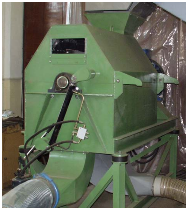
Bild 12: Faseraufschlussmaschine nach dem Prinzip des Prallaufschlusses (FÜRL & HEMPEL 1999)
