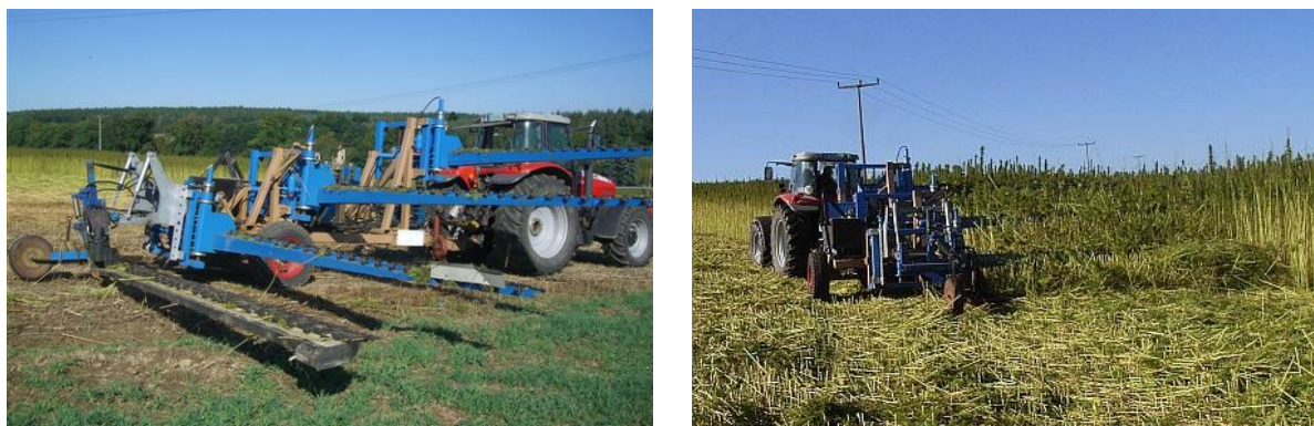
Bild 13: Prototyp des neuartigen Anhängengerätesystems zum Mähen und gleichzeitigen Einkürzen langstängliger Faserpflanzen mit einer Schnittbreite von bis zu 5 m (HMG 4-5000)
