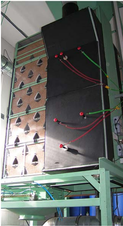
Bild 2: Foto (a) und Schema (b) der Dächerschachttrockner-Versuchsanlage
