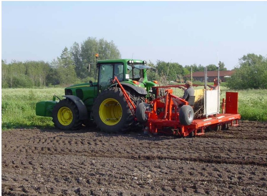
Bild 2: Vierreihige Steckholzpflanzmaschine mit Rutenbeschickung (Foto: Fa. Egedal Maskinfabrik A/S)
