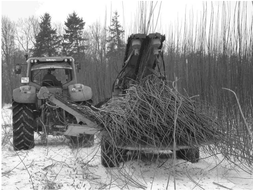
Bild 6: Gezogener Mähbündler Fröbbesta 92 der Fa. Bo Franzen bei der Ernte von Weiden (Foto: Scholz, ATB)
