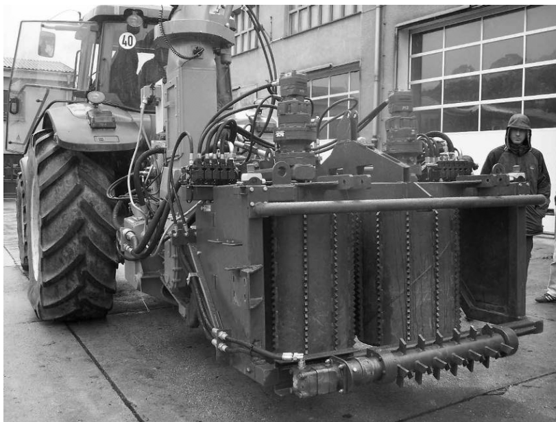
Bild 7: Anbau-Schwadhacker Jordan-Reihenhacker 25 der Fa. ForstTech GmbH (Foto: Scholz, ATB)
