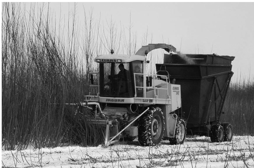
Bild 8: Claas-Feldhäcksler mit Feldholz-Schneidwerk HS-2 bei der Ernte von Weiden (Foto: Spikermann, ATB)
