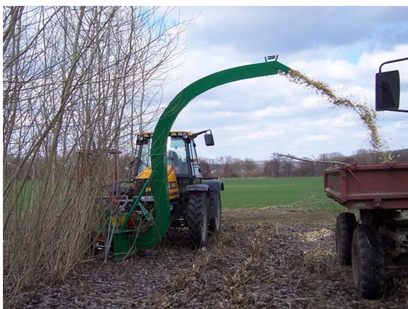
Bild 9: Einreihiger Anbau-Mähhackers bei der Ernte von Pappeln (Foto: Scholz, ATB)
