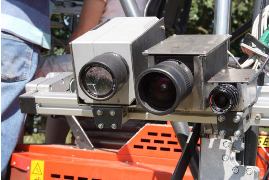
Bild 27: Mobiles Messwerfassungssystem, Thermal-, Multispektral-, und Farbbildindustriekamera (von links) an einer höhen- und winkelverstellbaren Halterung auf einem Hege-Geräteträger.
