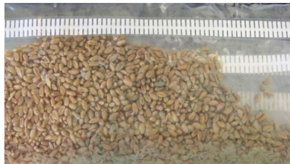
Bild 7: Weizen inokuliert mit Penicillium verrucosum (nach 8d) in einem Full-Gas Microsac (Fa. SACO 2 ).
