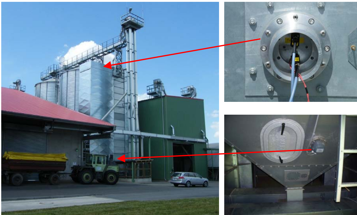
Bild 56: Großtechnische Erprobung der Mikrowellensensoren: Messorte am Industrietrockner.
