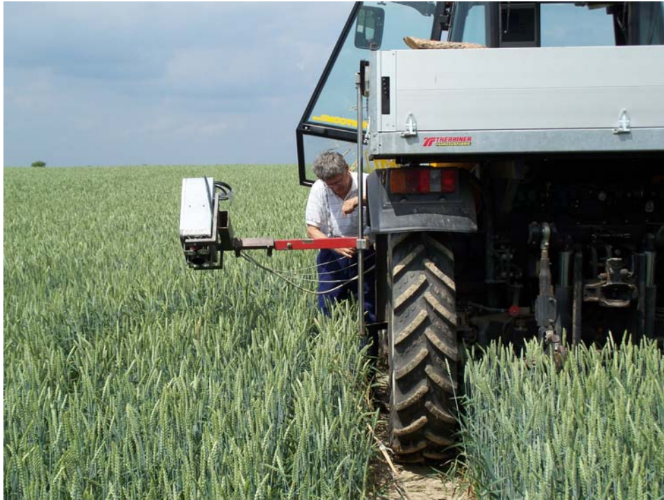
Bild 21: Multispektralkamera im Schutzgehäuse an einem flexibel verstellbaren Kameraträger für Versuche in Praxisflächen.
