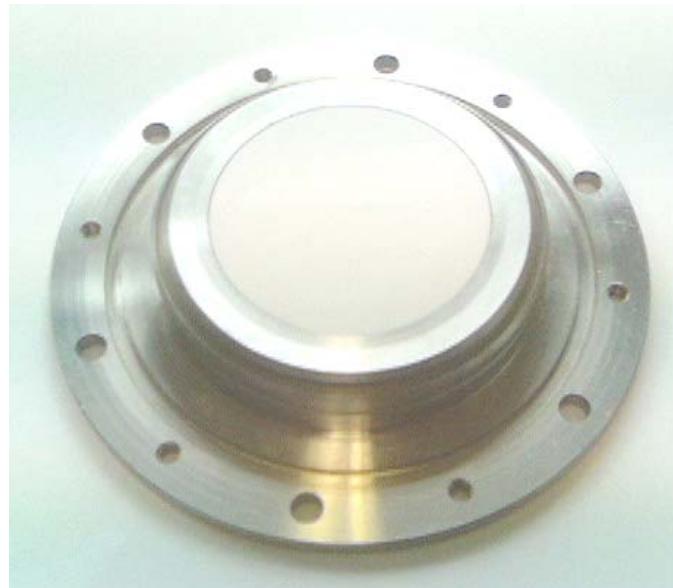
Bild 10: Prototyp des Sensors P66/50/4 für den erweiterten Feuchtemessbereich.
