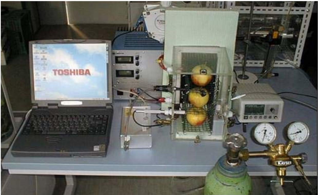
**Bild 7a:** Erster Messaufbau mit der Möglichkeit parallele Referenzdaten zum Fruchtgaswechsel durchzuführen
