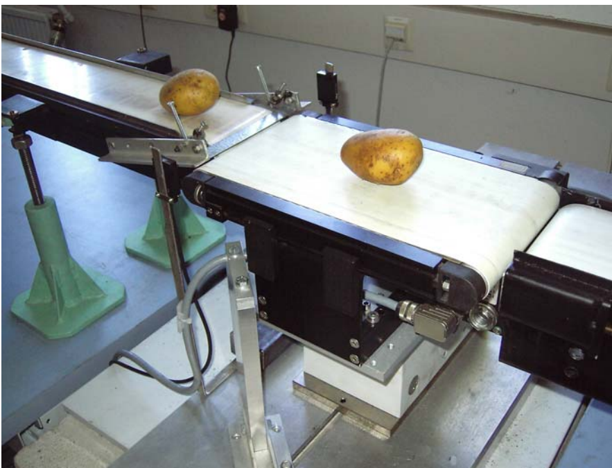
Bild 2: Bandwaage der Firma WIPOTEC mit Lichtschranken zum Auslösen der Messung
