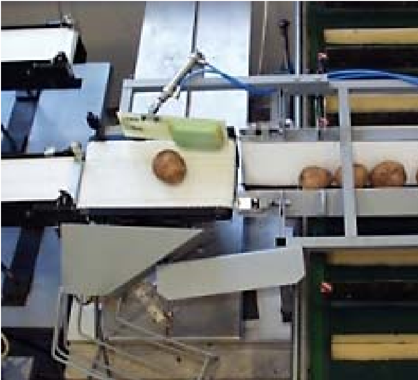
Bild 16: Klappbares V-Band mit vorgelagertem Auswerfer und einem Magazin zum Sammeln der ausgeworfenen Knollen
