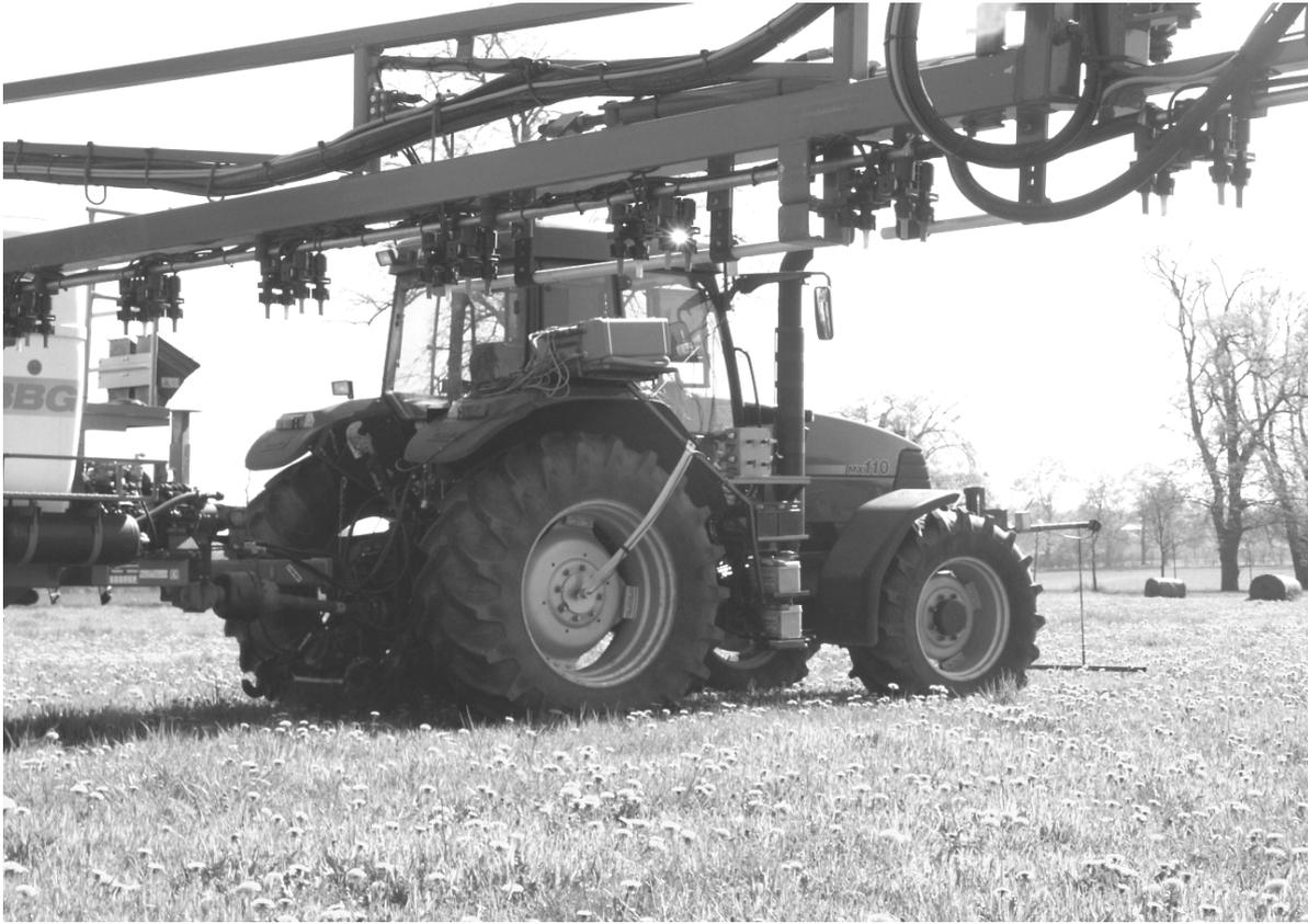
**Abb. 3:** Spritzgestänge mit Mehrfachdüsenträger von AMAZONE (Düsenkombination ID01, ID 015, ID 02, ID 04)
