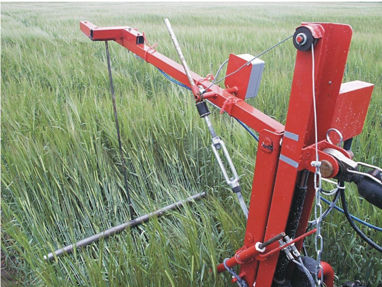
**Abb. 2:** CROP-Meter im Frontanbau der Zugmaschine
