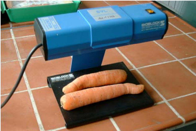
Bild 20: Versuchsaufbau für Bestrahlungsversuche im Labor
