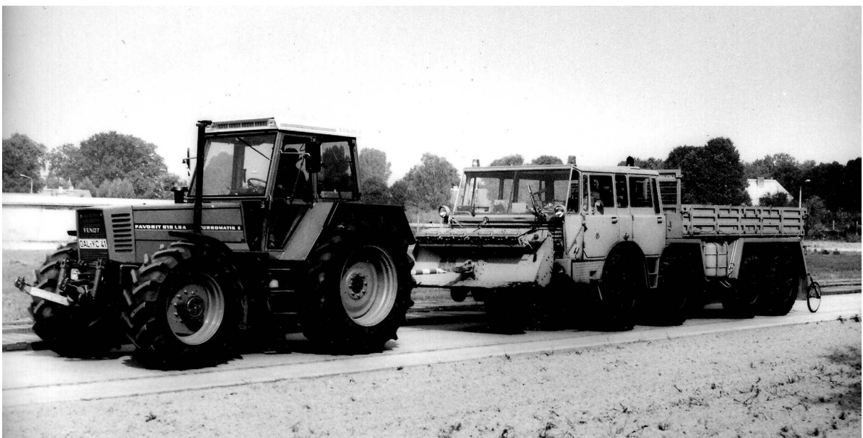
Abb. 7: Bremsfahrzeug für Zugkraftmessungen bei einer Messfahrt.
