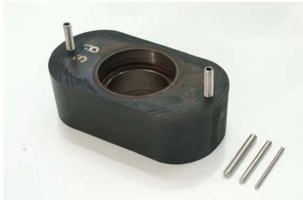
Bild 52: Nachstellbare Kopfspalte bei Ovalkolben
