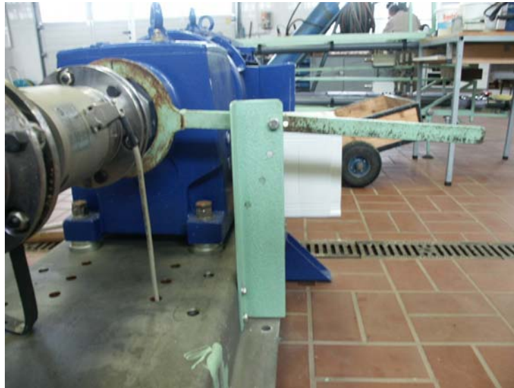
Bild 18: Fixierung der Bremspumpe
