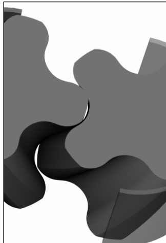
Bild 37: Axiale Öffnung im Mittenspalt
